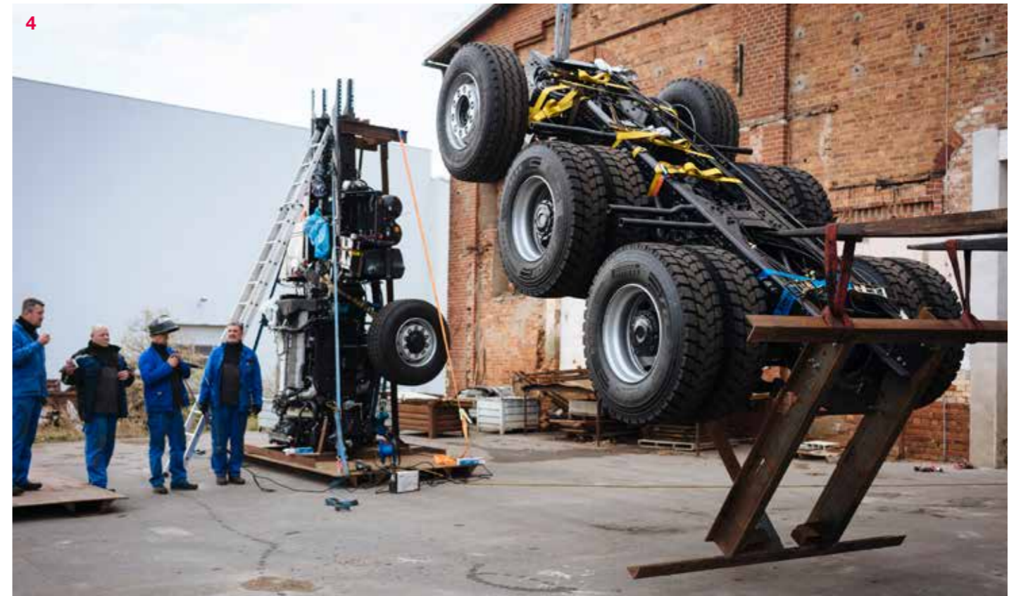
4 Bereit zum Transport Nur in Einzelteilen passt der Lkw in den Förderkorb des Bergwerks.
