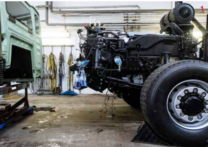
1 In der Werkstatt Fahrerhaus, Fahrgestell und Aufbau des Trucks werden in mehrere Teile zerlegt.
